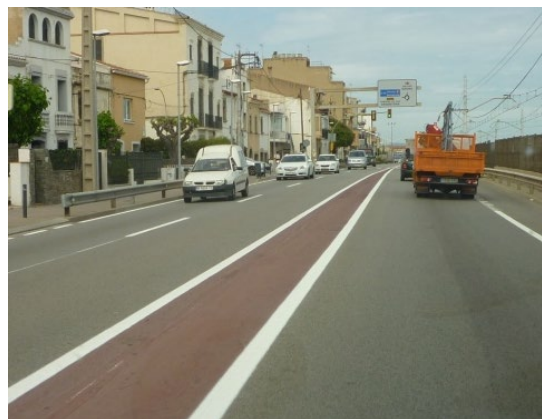
Imatge 56. Exemple en què s'ha establert una mitjana pintada, estrenyent els carrils de circulació.
